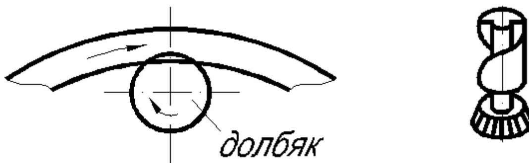
Для нарезания цилиндрических колёс с косыми зубьями необходимы специальные долбяки. Угол наклона зубьев долбяка должен равняться углу наклона зубьев нарезаемого колеса. Для нарезания колёс наружного зацепления направление наклона зубьев долбяка должно быть противоположным, а для нарезания колёс внутреннего зацепления – одноименным. Дополнительный к основному вращению поворот долбяка при помощи специальных винтовых направляющих копиров.
