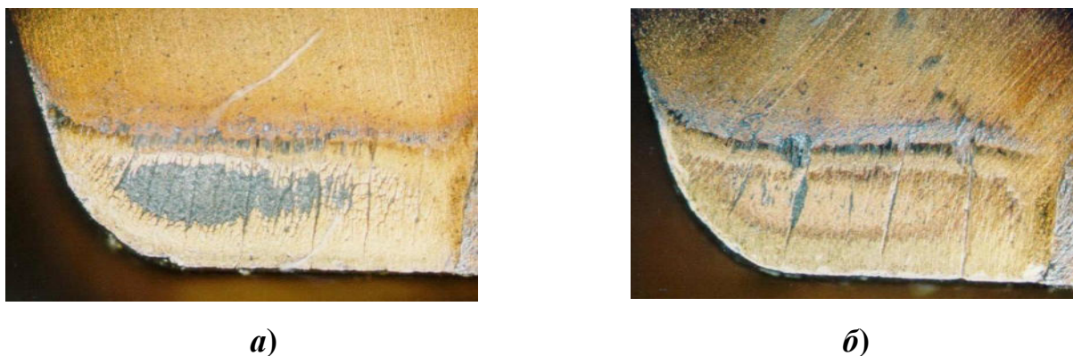
Рис. 4.26. Фотографии контактных площадок режущего инструмента с многослойными покрытиями:
