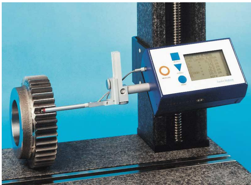
Рис. 4.45. Профилومتر Surtronic 25 фирмы TaylorHobson
