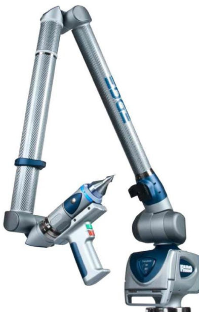
Рис. 4.20. Мобильная координатно-измерительная машина FARO
