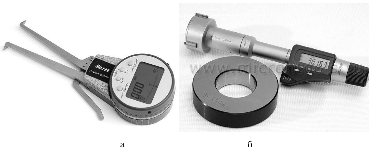
Рис. 4.24. Цифровые нутромеры: а – двухточечный; б – трехточечный
