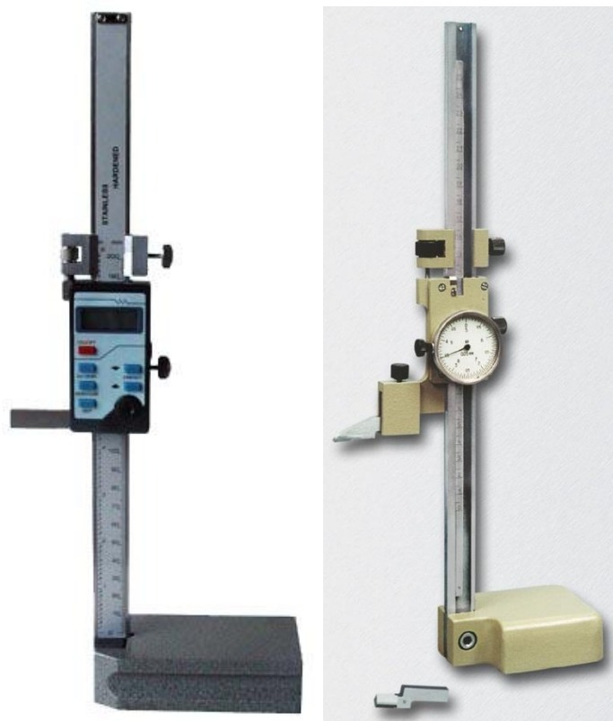
Рис. 4. 10. Штангенрейсмасы: а – со стрелочным отсчетным устройством; б– с цифровой индикацией
