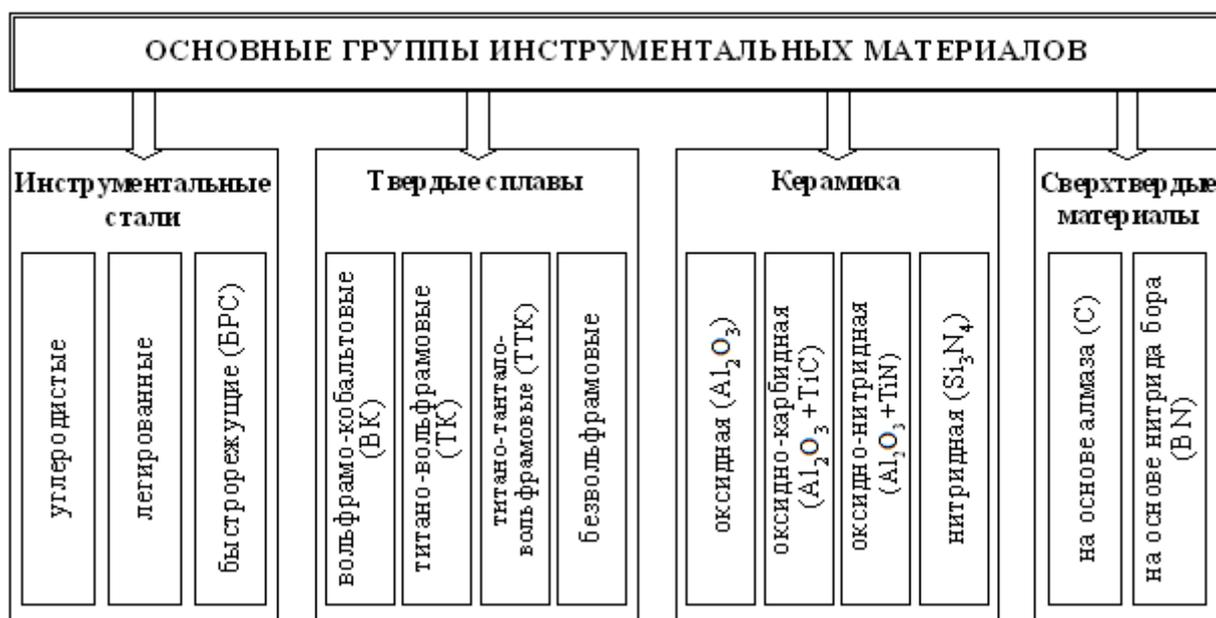
Рис. 1.1. Классификация инструментальных материалов
