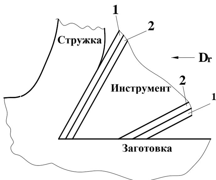
Рис. 2.4. Схема конструкции многослойного покрытия
