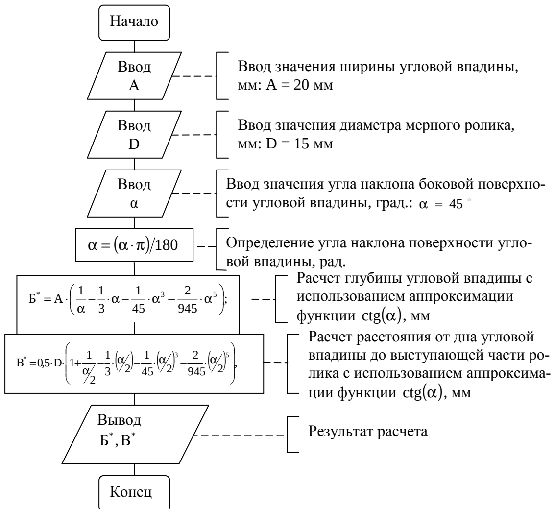
Рис. 4.5. Блок-схема алгоритма нахождения технологических размеров угловой впадины на поверхности заготовки с помощью мерного ролика (постановка задачи см. пример 10, расчетная схема см. рис. 4.4)
