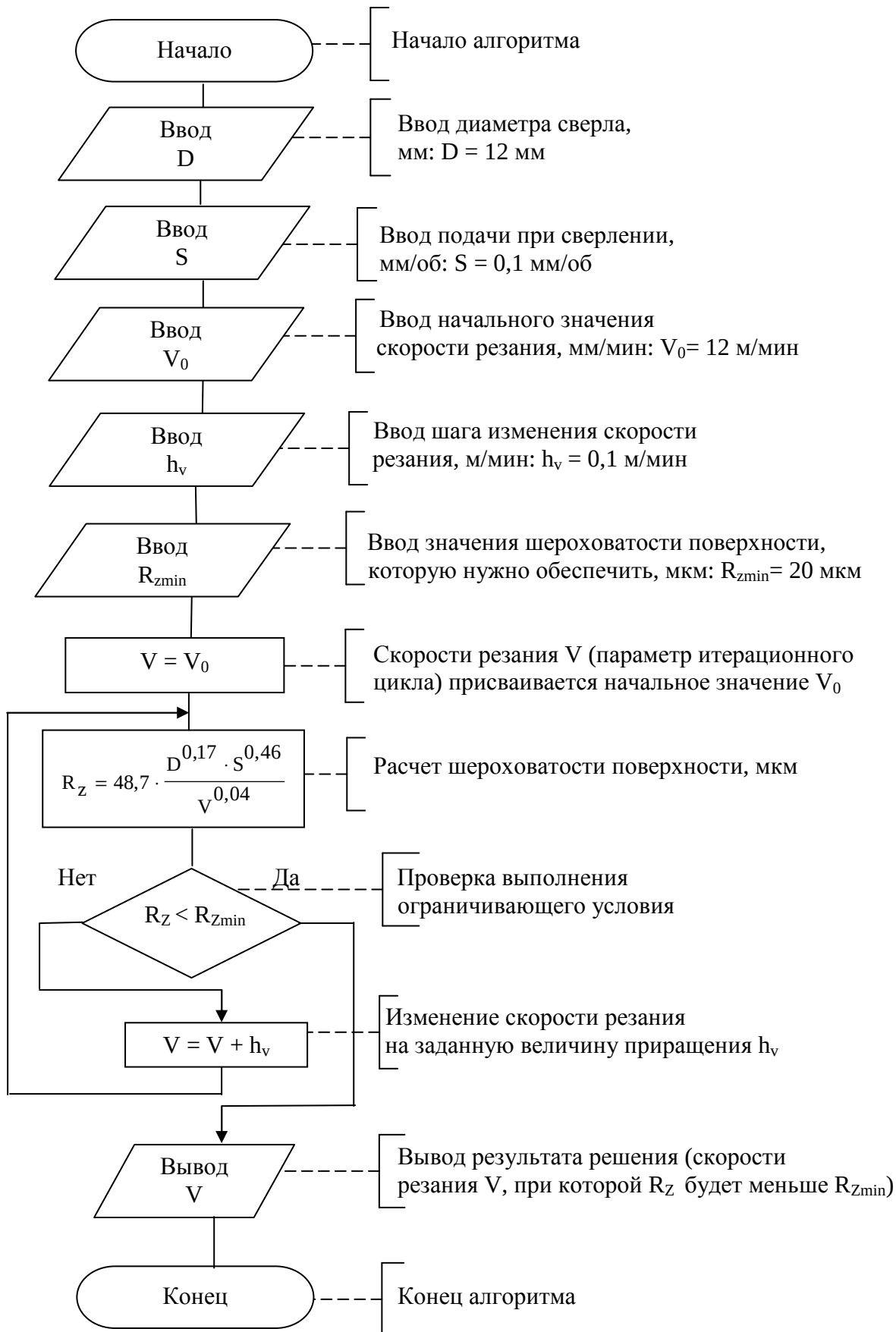
Рис. 1.7. Блок-схема алгоритма итерационного цикла (постановка задачи см. пример 6)
