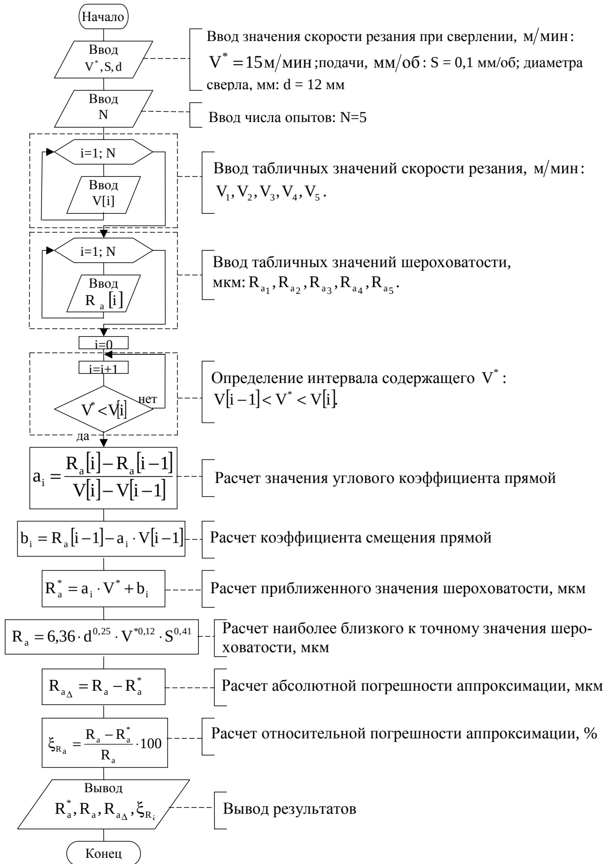
Рис. 4.10. Блок-схема алгоритма нахождения приближенного значения выходного параметра R_a^* при реализации локальной линейной интерполяции (постановка задачи см. пример 10)
