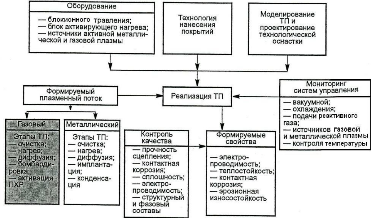
Рис. 4.8. Комплексная система получения заданных свойств поверхности титановых сплавов при ВИПО
