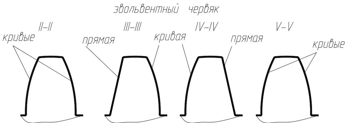
Рис. 1.12. Профиль зуба ЧМФ на основе эвольвентного червяка в сечениях I-IV
