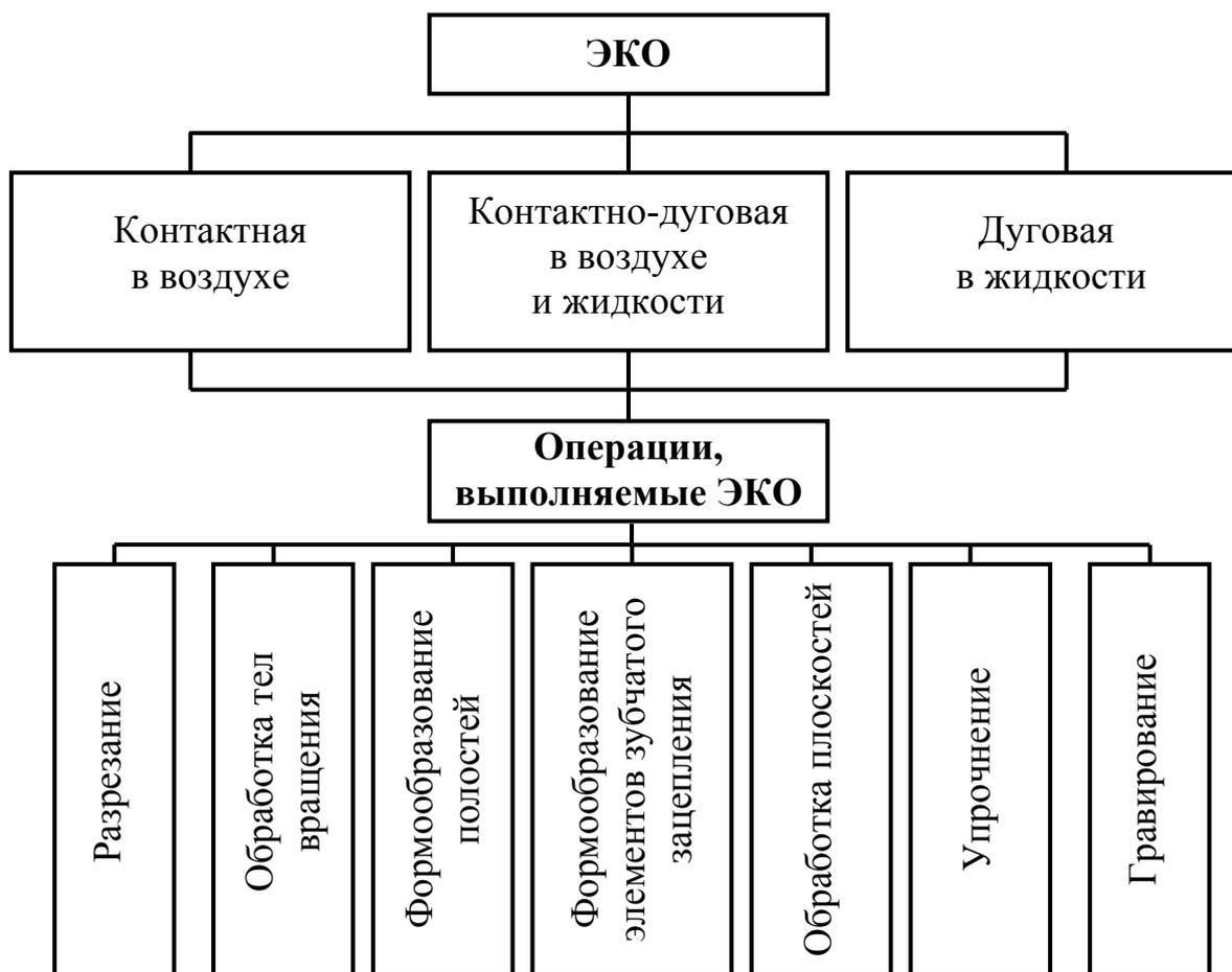
Рис. 2.2. Классификация видов электроконтактной обработки
