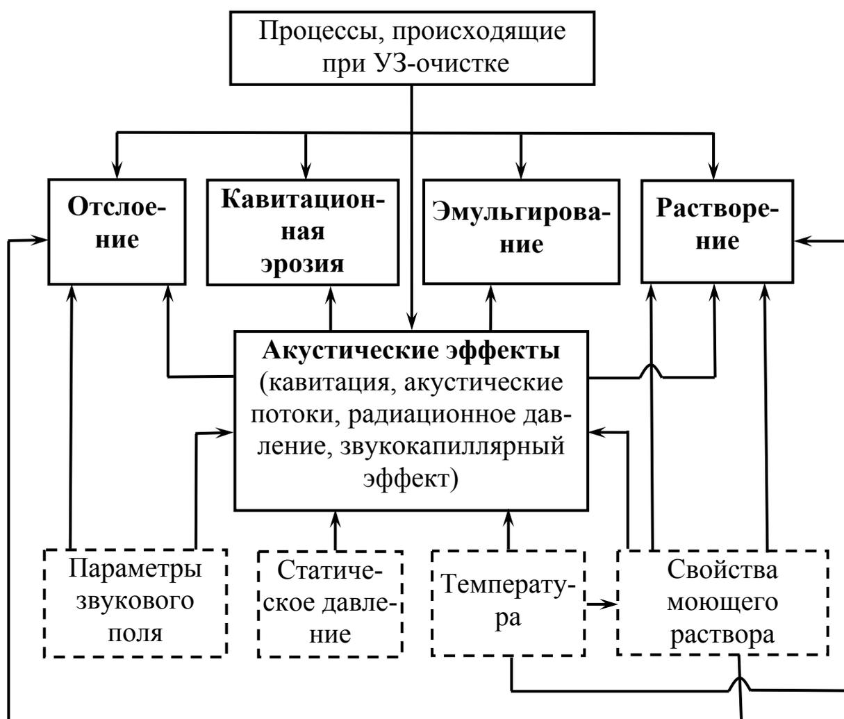
**Рис. 6.1. Схема взаимосвязи процессов, происходящих при УЗ-очистке, с элементами режима ее проведения**
