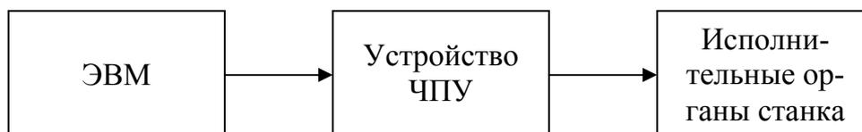
Рис. 3.1. Схема управления фрезерного станка 6P11Ф3-01
