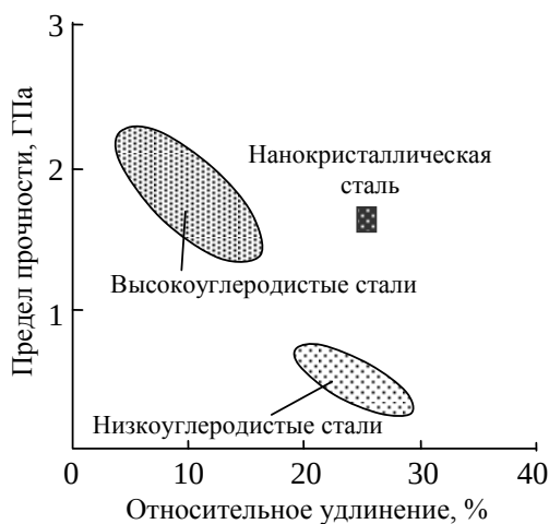
Рисунок 5.14 Соотношение между прочностью и пластичностью для сталей
